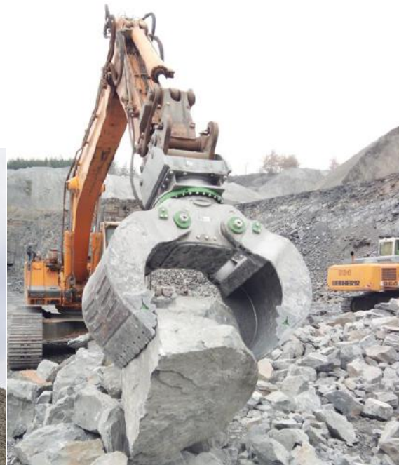
Alligator-Greifer MD20.0, Komatsu-Maschinen Traktoristy, Russland
