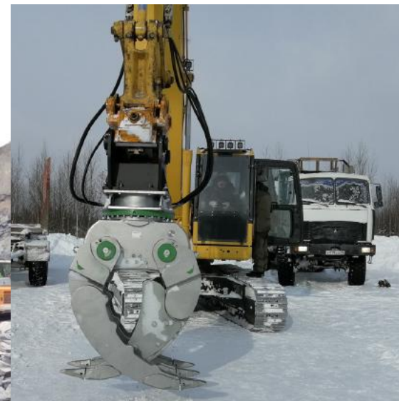
Alligator-Greifer MD20.0, Komatsu-Maschinen Traktoristy, Russland
